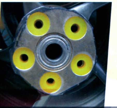
La leggera corona in ergal è abbinata ad un parastrappi dello stesso materiale, a cui vengono abbinati rondelle in materiale plastico. La scelta della durezza più indicata ha richiesto a Paolo vari collaudi, e nella foto in alto a destra è possibile vedere le tre versioni provate.
