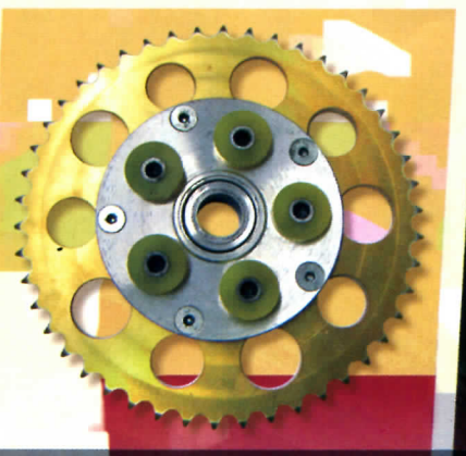
La leggera corona in ergal è abbinata ad un parastrappi dello stesso materiale, a cui vengono abbinati rondelle in materiale plastico. La scelta della durezza più indicata ha richiesto a Paolo vari collaudi, e nella foto in alto a destra è possibile vedere le tre versioni provate.
