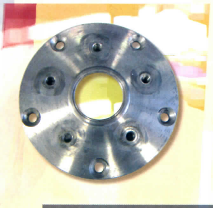
La leggera corona in ergal è abbinata ad un parastrappi dello stesso materiale, a cui vengono abbinati rondelle in materiale plastico. La scelta della durezza più indicata ha richiesto a Paolo vari collaudi, e nella foto in alto a destra è possibile vedere le tre versioni provate.
